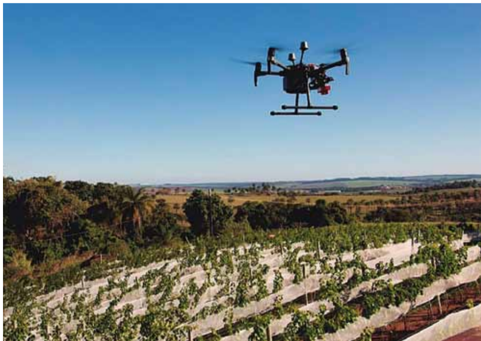
Tecnologia: drone faz voos próximos da plantação para realizar medidas que ajudam a estimar o teor de clorofila e os índices vegetativos das videiras
